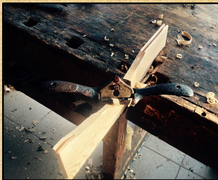
Szárnyas vagy íves gyalu, az ívelt, nehezen hozzáférhető felületek megmunkálására használatos.
