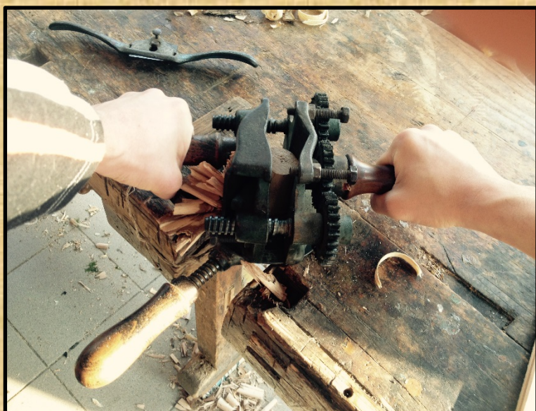
A kevesek által ismert bognár gyalu, a szakmában bognárbokázó néven is emlegetik. Míg a többi gyalu leginkább sík felület alakítására használható, ez a szerszám hengeres felületek gyalulására alkalmas.
