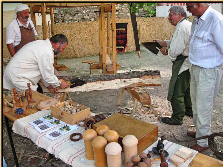
A kétkézes ácsbárddal vagy faragóbárddal a mesteremberek hasábformát alakították ki a henger alakú rönkből.
