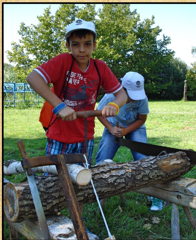
Cigányfúró, amellyel nagyméretű faszegek előfuratát készítették.
